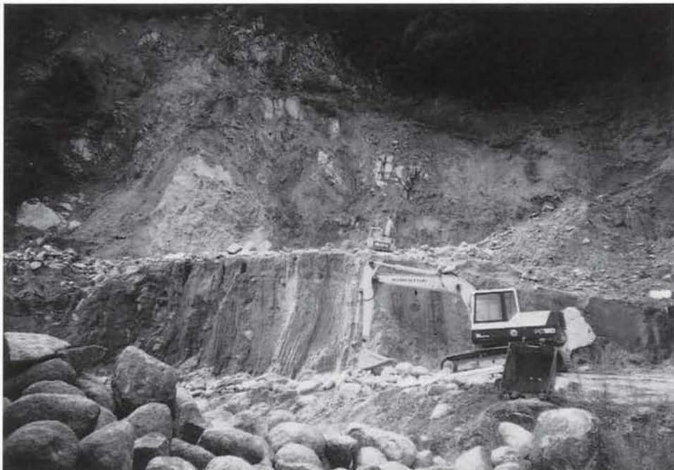
第22図 小規模トータル岩の採掘場 鞍馬石としてトータル岩が採掘されている。トータル岩は強く風化しマサ化しているが、球核状に新鮮な岩石の部分が含まれる。写真手前に採掘された新鮮な鞍馬石が積まれている。(京都市左京区花脊峠南西方)
