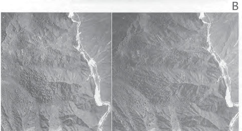
第64図 本地域の大規模崩壊地形の航空写真 平行法で立体視可能. ともに画面上が北. 航空写真は国土地理院発行の1:15,000カラー空中写真(昭和50年(1975年)9月10日-10月22日撮影)を用いた.
