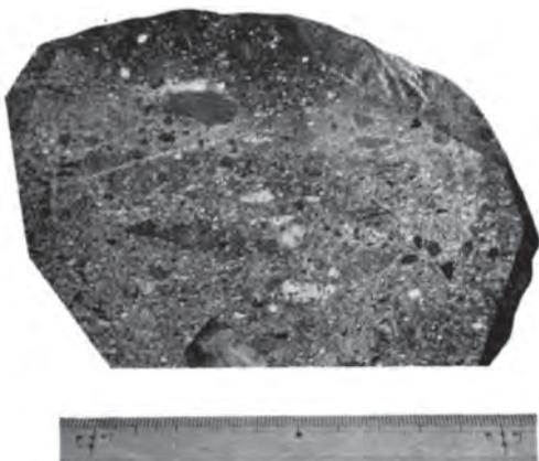
図版V 古生層（チャート・粘板岩）の捕獲岩片に富む熔結凝灰岩：濃飛流紋岩類
