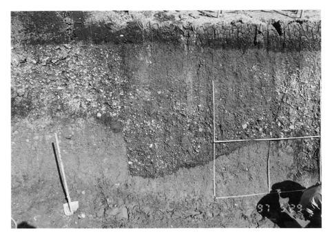
第69図 武山断層のトレンチ発掘露頭(横須賀市津久井5丁目,津久井小学校南側,津久井トレンチ No.1 東壁) 写真右が南側,活断層の主断層が見られる。みかけの垂直落差は、南落ち約74cm. 1997年5月撮影
