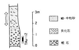
第55図 大津砂泥層の地質柱状図と試料採取位置(大村ほか, 1984) 白抜きの矢印は非造礁性単体サンゴ,黒の棒はTAu-12テフラの各採取範囲. 採取地点は第51図の地点23付近(35°15′22″N, 139°43′13″E).
