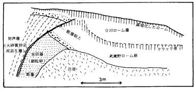
第70図 南下浦断層の写真とスケッチ(三浦市南下浦中学校東) 写真のスケールは1m,その中央部が南下浦断層.スケッチは岡(1996)の第10図
