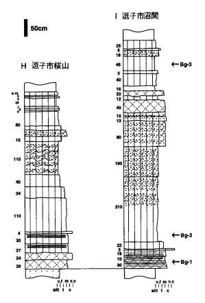
第42図 凝灰岩鍵層 Bg の柱状図 露頭位置は,第38図.図中のHは,ト部(1992)と同一地点で記載を修正した.凡例は,第36図に同じ.
