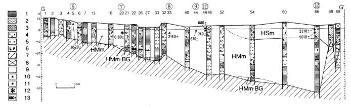
1. 粘土 2. シルト 3. 砂 4. 礫 5. 泥炭 6. 貝 7. 基盤岩 8. 人工埋土 9. 不明 10. 干潟群集 11. 内湾砂底群集 12. 内湾泥底群集 13. <sup>14</sup>C 年代値 HMm・BG:平作層下部層(沖積層基底礫層) HMm:平作層下部層 HSm:平作層上部層
