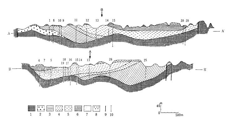
第50図 宮田台地とその周辺の地質断面図 [奥村ほか(1977)に加筆] 1.基盤岩 2.林凝灰質礫岩層 3.須軽谷砂部層 4.津久井浜砂礫部層 5.高円坊砂部層 6.鹿穴凝灰質砂部層 7.一町田砂部層 8.小原台・三崎砂礫層及びローム層 9.断層 10.深井戸またはボーリング位置
