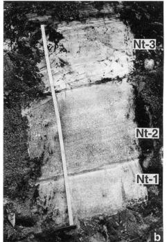
第47図 凝灰岩鍵層 Nt の露頭写真 逗子市外木9丁目(模式地:第38図,第46図-O).a図は法性寺参道での露頭位置.b図は凝灰岩鍵層部分の拡大.
