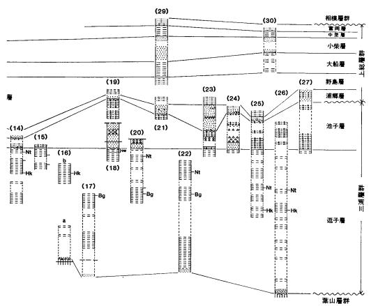
A: 泥岩 B: 砂質泥岩 C: 泥岩(砂岩を挟む) D, E: 凝灰質泥岩砂岩互層(D: 凝灰質泥岩優勢, E: 砂岩優勢) F: 凝灰質泥岩火砕岩互層 G: 凝灰質砂岩火砕岩互層 H: 凝灰質細粒砂岩 I: 凝灰質粗粒砂岩 J: 小ー中礫 (中・古生界起源) K: 大-巨礫(第三系起源) L: 火山礫凝灰岩 M: 斜交葉理N: 凝灰岩鍵層 O: スランプ構造 P: 不整合(破線は推定) Q: 非整合 R: 断層(破線は推定)
