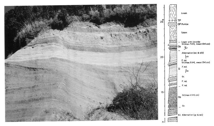
第52図 走水礫層及び上位層の柱状図と露頭写真(横須賀市小原台にある防衛大学南西側)(1971年 1月江藤撮影)
