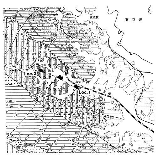
第16図 横須賀市北部地域の超塩基性岩の分布と試料採集地点図 黒色部が超塩基性岩体,この地質図は江藤(1986a)の第3図の一部分で凡例は省略した. Loc. 2 は第17, 18図に示される.
