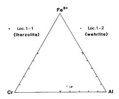
第20図 蛇紋岩中のクロムスピネルの Fe-Cr-Ar 三角図(江藤, 1986a)
