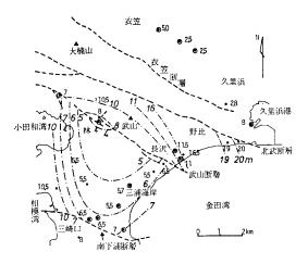
第60図 三浦半島南部の縄文海進最高期における海成層の上限高度分布(松島, 1980) ◎: 実測による海成層の上限高度(m) ●: ボーリングによるその高度(m)
