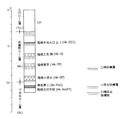
第56図 ローム層の模式総合柱状図 町田・新井(1992)と宮内(1996)により小玉ほか(1980)の一部改変
