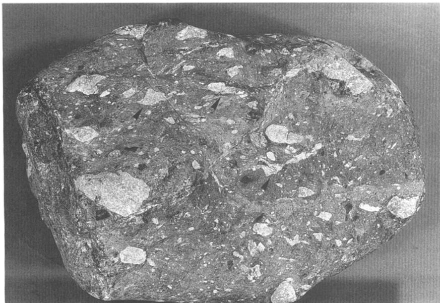
第15図 松前層群S<sub>6</sub>ユニット中の著しい変形を受けた岩片(矢印)を含む岩礫泥岩(白神岬、スケールは5cm)
