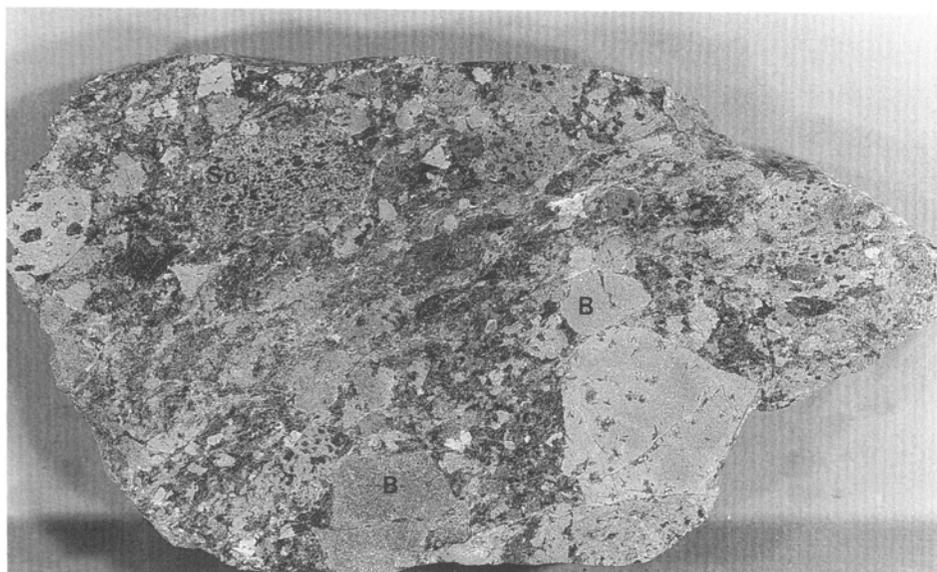
第12図 松前層群S<sub>1</sub>ユニット中の塩基性ハイアロブレッチア。発泡の著しいもの(Sc)と発泡のほとんど見られない(B)玄武岩片(小股川上流、スケールは5cm)
