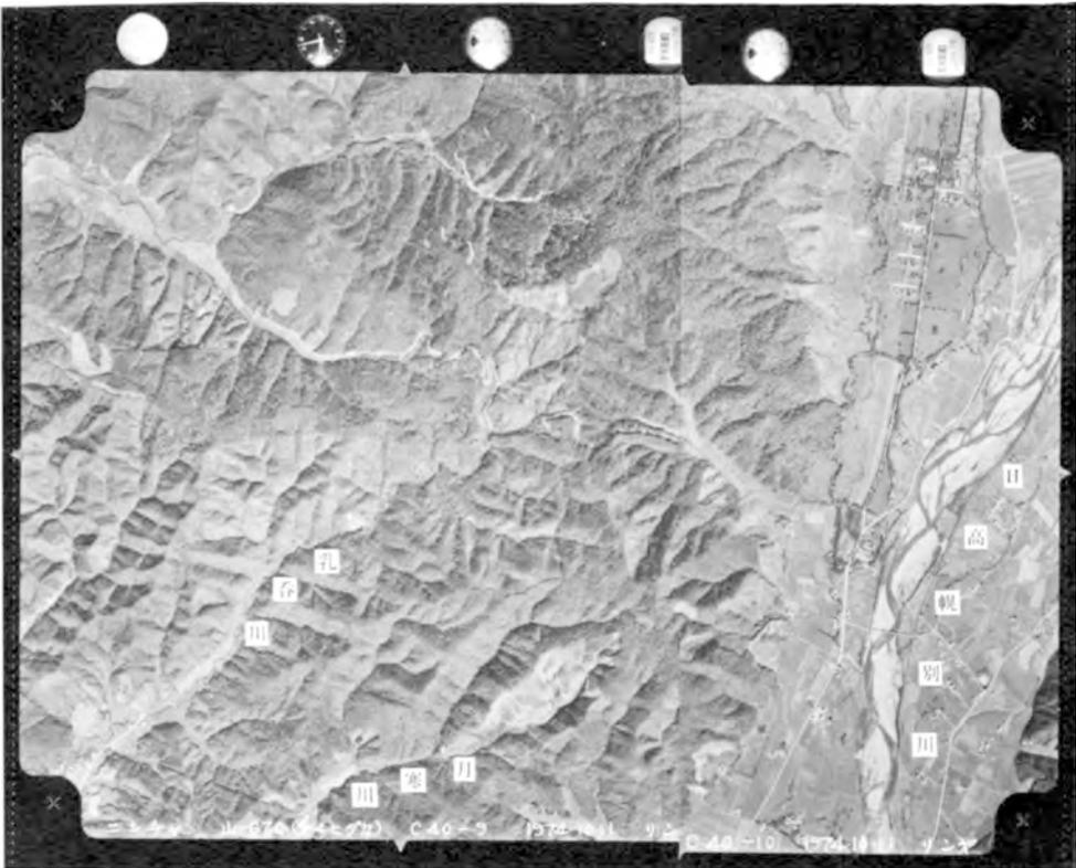
第 48 図 乳呑川中・上流地域の空中写真 地層はほぼ直立して、砂岩層は稜線を形成している。第 46・51 図を参照。林野庁撮影の空中写真(山-670, C40-9,10)の複製を使用
