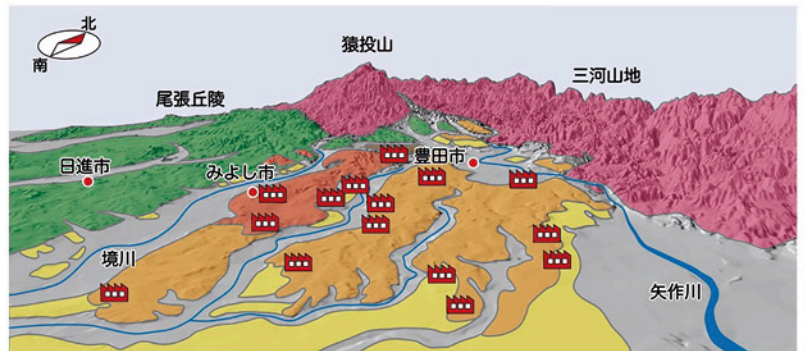
豊田地域の立体地質図と自動車工場的位置図。最高位の段丘面（茶色）、高位の段丘面（薄茶色）、中位の段丘面（黄色）、現河床面（灰色）が分布する。広大で平坦、頑丈な地盤である最高位と高位の段丘面上に自動車工場が位置している。（背景の立体図は地理院地図の3Dデータ表示を使用）
