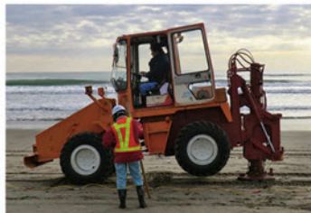
人工地震を起こす震源車を用いた反射法地震波探査。
