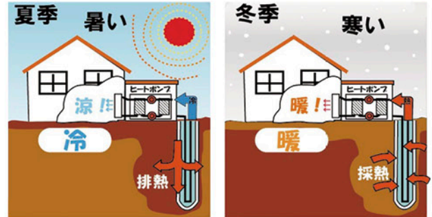
左) 冷房運転: 室内から地中へ排熱, 右) 暖房運転: 地中から室内へ採熱。
