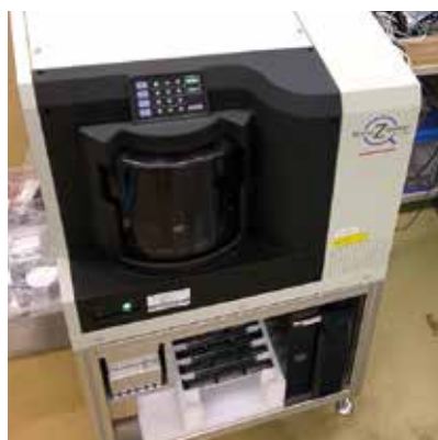
図4 バーチャルスライドスキャナーの外観（左）、バーチャルスライドスキャナーの内部（右）。バーチャルスライドスキャナーの中には多数のスライドが搭載されている。
