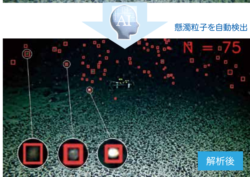
写真2 解析の元画像（上）と解析後の画像（下）。AI技術によって自動検出された懸濁粒子が赤い四角形で囲まれている。
