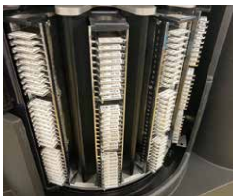
図4 バーチャルスライドスキャナーの外観（左）、バーチャルスライドスキャナーの内部（右）。バーチャルスライドスキャナーの中には多数のスライドが搭載されている。
