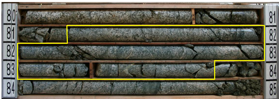
図 6 孔 2 電気伝導率変化区間のコアの状況
