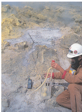
4.黒燃における火山ガスの採取。高温の噴気孔(733℃；写真中央の温度計)の火山ガスを冷却し、微量金属元素やトリチウム濃度を測定するための凝縮水試料を採取している。(1993年10月)
