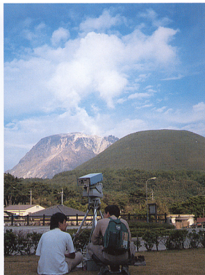
11. 長浜港から東に稲村岳・硫黄岳を望む。中央の機器は火山から放出されている噴煙中の SO 2 濃度を測定するための COSPEC (相関スペクトロメーター)。SO 2 の放出量の測定は、火山活動の監視や火山性熱水系の規模の推定などを行なう上で重要である。(1990年10月)
