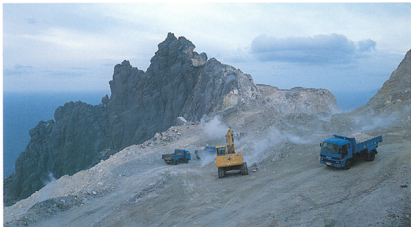
9. 硫黄岳山頂火口南東縁部における珪石の採石。流紋岩が HCl や SO 2 を含む火山ガス起源の酸性溶液により溶脱を受け、高純度 (>90% SiO 2 ) のアモルファスシリカからなる珪石が生じている。発泡コンクリートなどの原材料として用いられる。(1993年10月)
