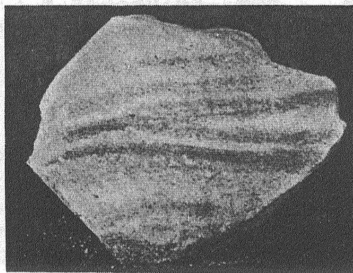
第8図 アクリル系樹脂（アクリルアミド）を注入して固結したシラス
